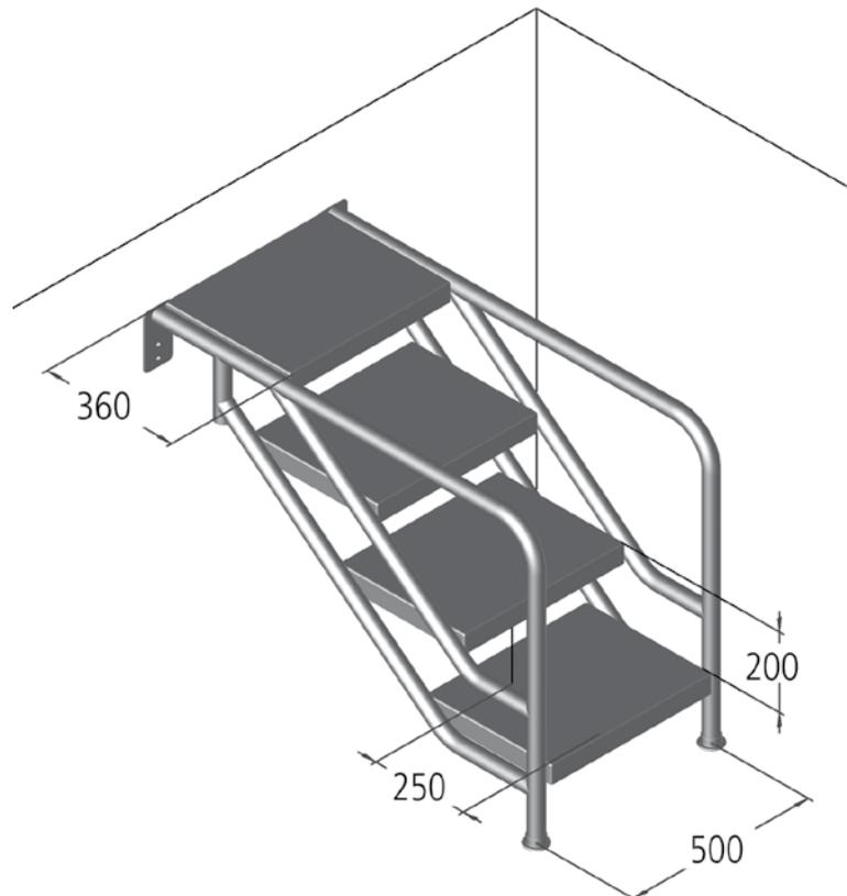
Detail Stufenprofilierung //
