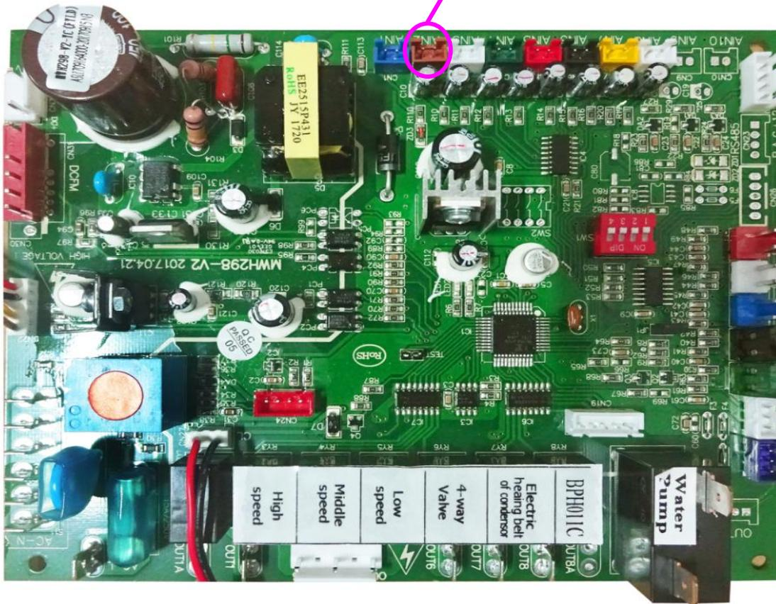
Prüfen, ob die Verdrahtung des Wasserausgangstemperaturfühlers richtig angeschlossen ist.
