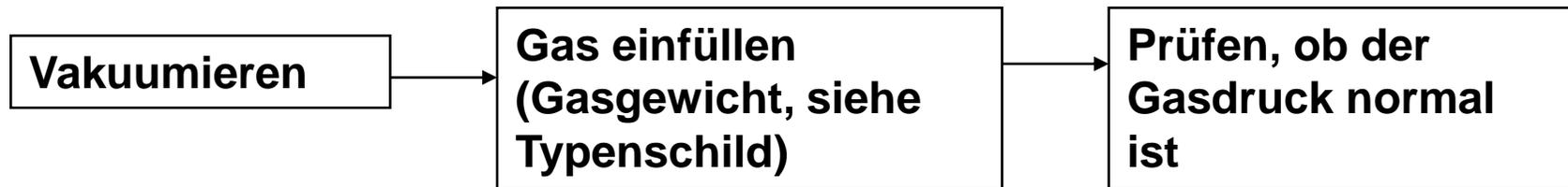
**Hinweis: Füllen Sie Gas über das Niederdruckventil nach.**
