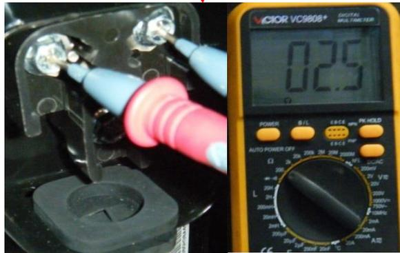
**Foto links: gleicher Widerstand zwischen zwei beliebigen Klemmen des Verdichters, d. h. der Verdichter ist in Ordnung. Ist jedoch einer von ihnen Null oder unendlich, bedeutet das einen Ausfall. Ersetzen Sie den Verdichter.**
